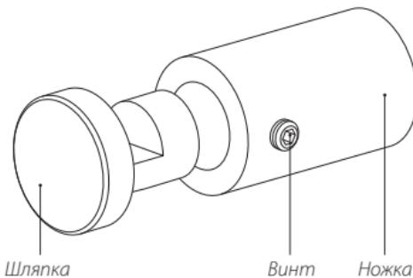
Рисунок 2. Конструкция дистанционного держателя
