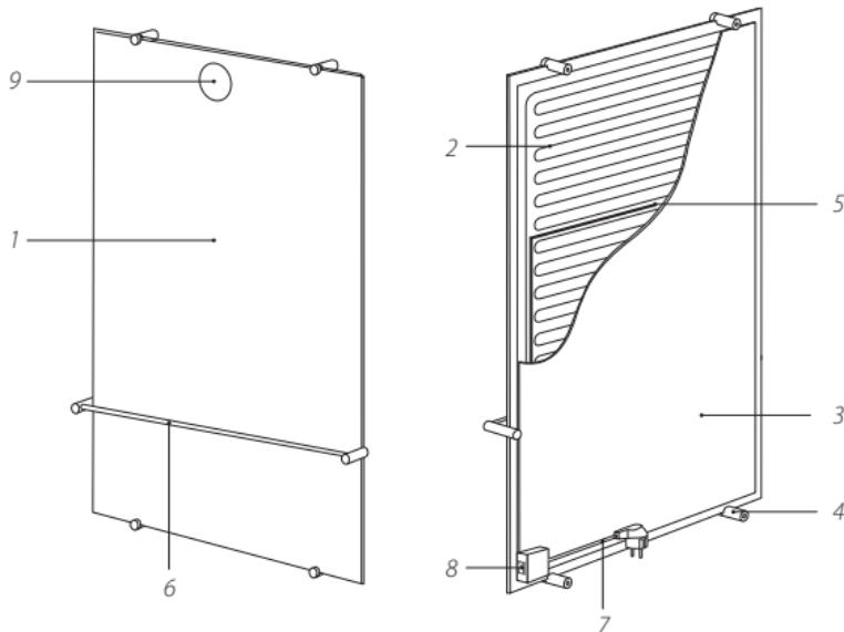
Рисунок 1. Основные элементы конструкции полотенцесушителя
