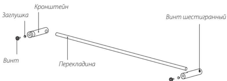
Рисунок 3. Конструкция перекладины для полотенца
