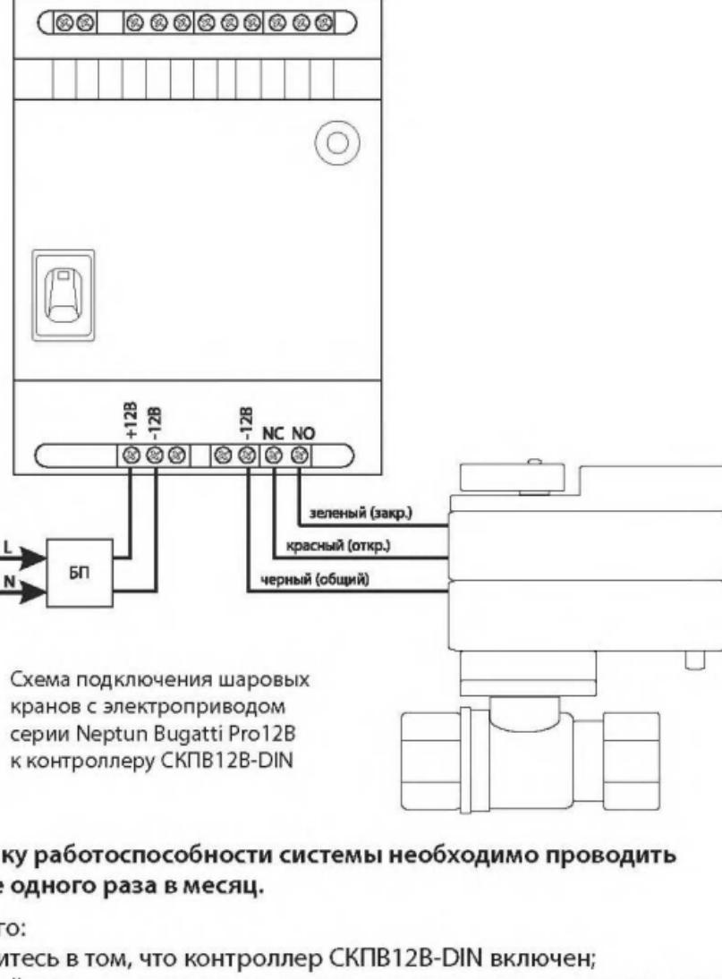
Схема подключения шаровых кранов с электроприводом серии Neptun Bugatti Pro12B к контроллеру СКПВ12В-DIN
