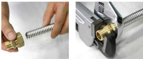
При затягивании гайки рекомендуем пользоваться следующей таблицей усилий:
