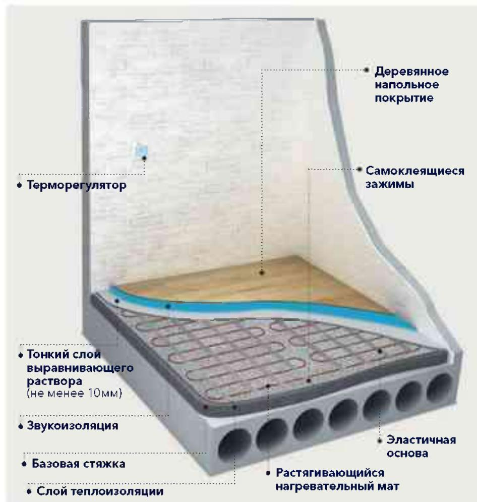
**Вариант установки двухжильного кабеля на площади сложной конфигурации в бетонную стяжку**
