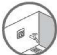
В помещениях с повышенной влажностью размещайте термостат в соответствии с местными нормами по классам защиты IP.
