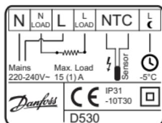
При подключении внешнего таймера к контакту, маркированному символом луны (и при использовании, например, той же фазы, что и для сетевого питания), термостат можно запрограммировать на снижение температуры на 5 °C в течение определенных периодов времени.
