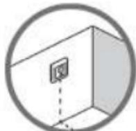
**Примечание:** Датчик температуры пола обеспечивает более точную регулировку температуры, рекомендуется для обогрева всех типов полов и **обязателен** к применению при обогреве деревянных полов во избежание их перегрева.
