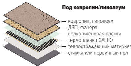
Рис. Схема монтажа теплого пола CALEO под ламинат, ковролин, линолеум
